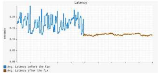
図 2. 真の共有問題を特定して対処した後、レイテンシーが大幅に減少しているのがわかります。 1
